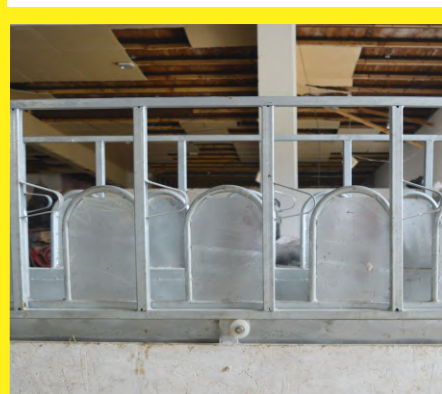
Marcos internos de forma circular con mecanismo de bloqueo de cabeza de masa
