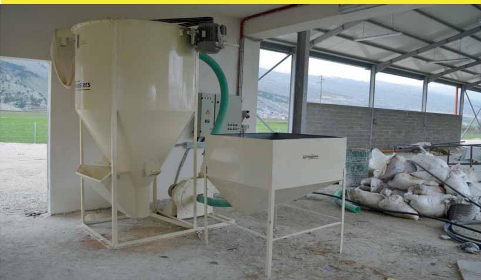
**Σπαστήρας αναμεικτήρας ζυγαριά**
